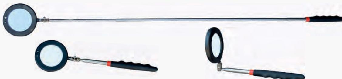
Смотровое круглое зеркало на телескопической рукоятке со светодиодной подсветкой (2 светодиода). Диаметр зеркала: 51 мм; длина: 280-265 мм. Предназначено для осмотра труднодоступных мест.
