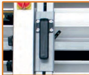
Механизм регулировки по высоте позволяет очень легко менять положение ИК-сушки одной рукой.
