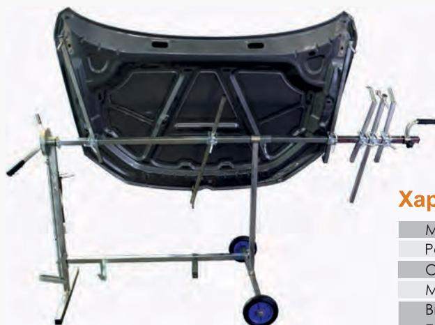
Поворотный стенд для окраски и сушки съемных элементов: дверь, бампер, крыло и т. д.
