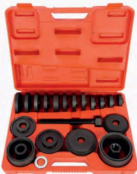
Набор для выпрессовки и запрессовки подшипников позволяет производить замену подшипника колеса без демонтажа снятия поворотного кулака и стойки, выполнен из закаленной инструментальной стали, подходят для Audi/Opel/Ford/Honda/Fiat/Mercedes Benz/BMW/VW/Toyota/Peugeot/Citroen/Renault/Mazda/Mitsubishi/Nissan.
