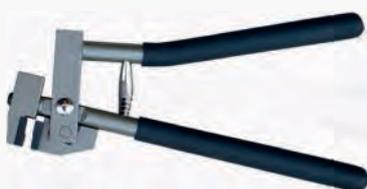
Кромкогиб жестящика. Позволяет сделать профиль кромки под сварку внахлест 1 см. Толщина металла до 1.2 мм.
