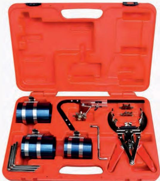
Набор для установки поршней в пластиковом кейсе. В комплекте: инструмент для прочистки канавок поршней, зачистные насадки, оправки с воротком.
