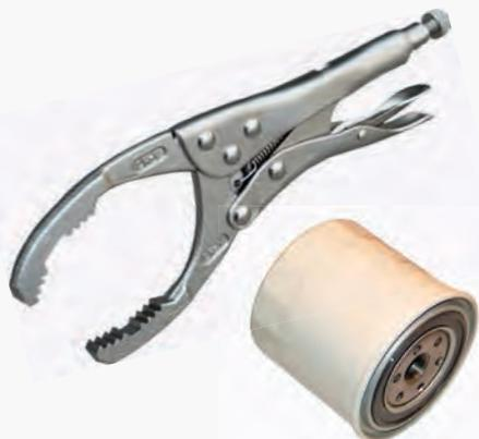
Съемник масляного фильтра. Зажим с фиксатором.
