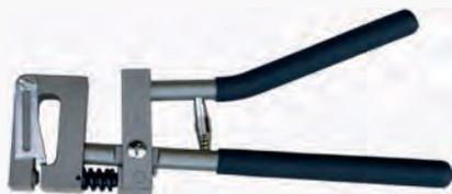
Дырокол кузовной для металла, размер отверстия 5 мм. Применяется при кузовном ремонте автомобилей. Толщина металла до 1.5 мм.
