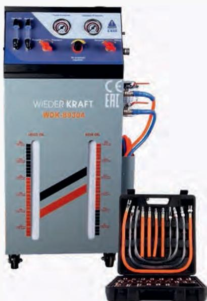
Установка для замены масла в автоматических коробках переключения передач.
